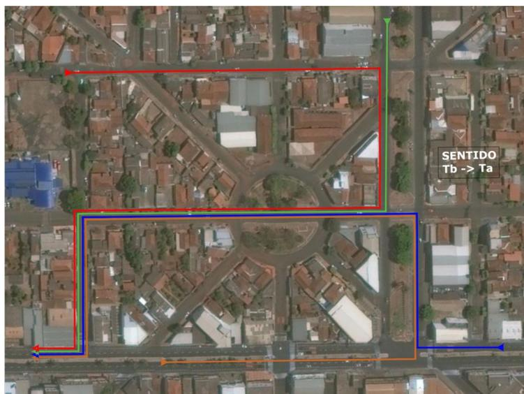
**Figura 6.5 – Esquema de circulação junto ao Terminal “B” dos ônibus que vão para o Terminal “A”.**
