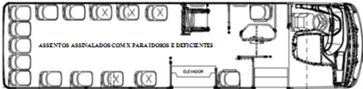
**Figura 3.3 – Desenho esquemático do arranjo interno dos miniônibus.**
