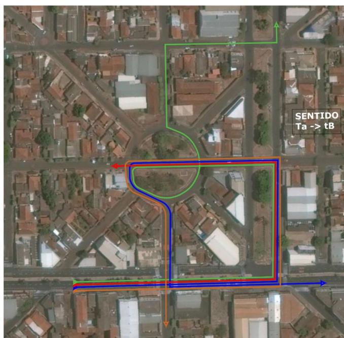
**Figura 6.5 – Esquema de circulação junto ao Terminal “B” dos ônibus que vêm do Terminal “A”.**
