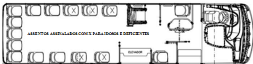
Figura 3 – Desenho esquemático do arranjo interno dos miniônibus.
